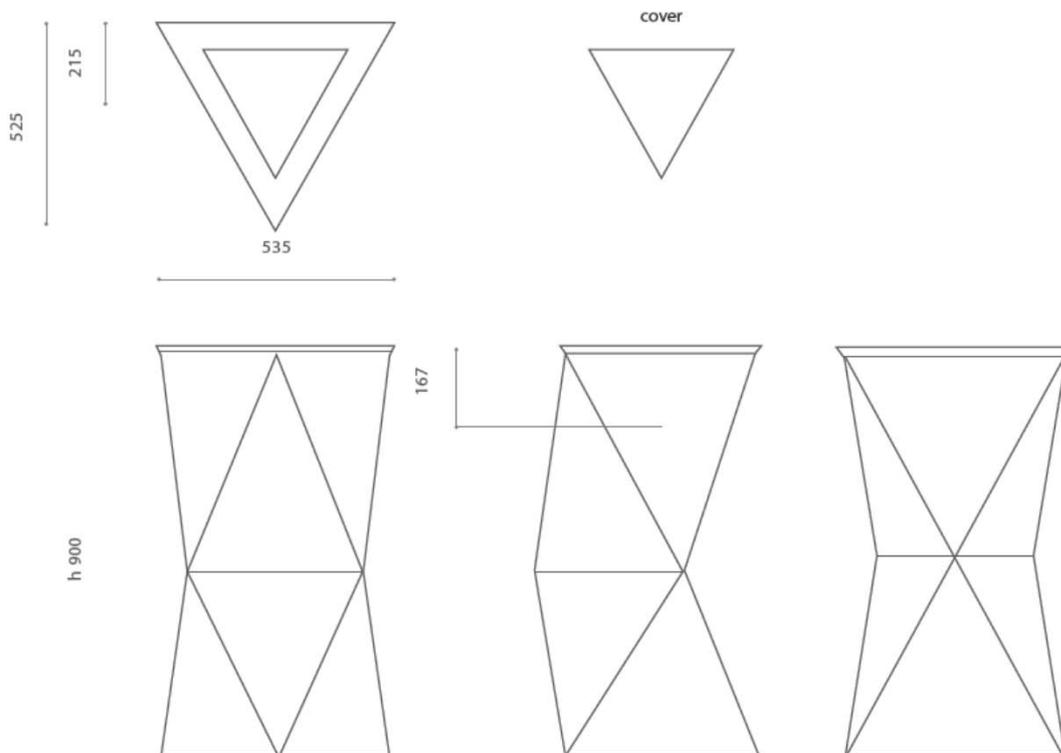
Die Maßtoleranzen (+/-3 mm) und Ebenheitstoleranzen (DIN 18202) unterliegen den üblichen materialspezifischen Toleranzen von Bau- und Werkstoffen, anlehnend an die DIN 18202. Lochbohrungen müssen nach Auflegen des Waschtisches auf die Trägerplatte angezeichnet werden.
